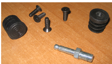
-VITI A TESTA SVASATA M6 -TAPPI PER PORTA RACLA 1420 -INSERTI FILETTATI M10 PER RACLA 1420
